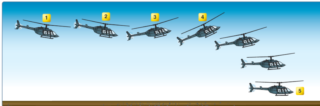
Obrázek 10-3. Rychlé zpomalení nebo rychlé zastavení.
