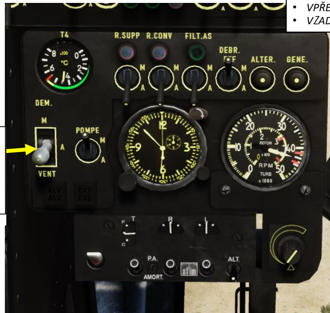
Spínač Startér/větrání (Démarreur) • M = Marche = Zapnuto (NAHORU) • A = Arrêt = Vypnuto (STŘED) • VENT = Větrání, suché klička (DOLŮ)
