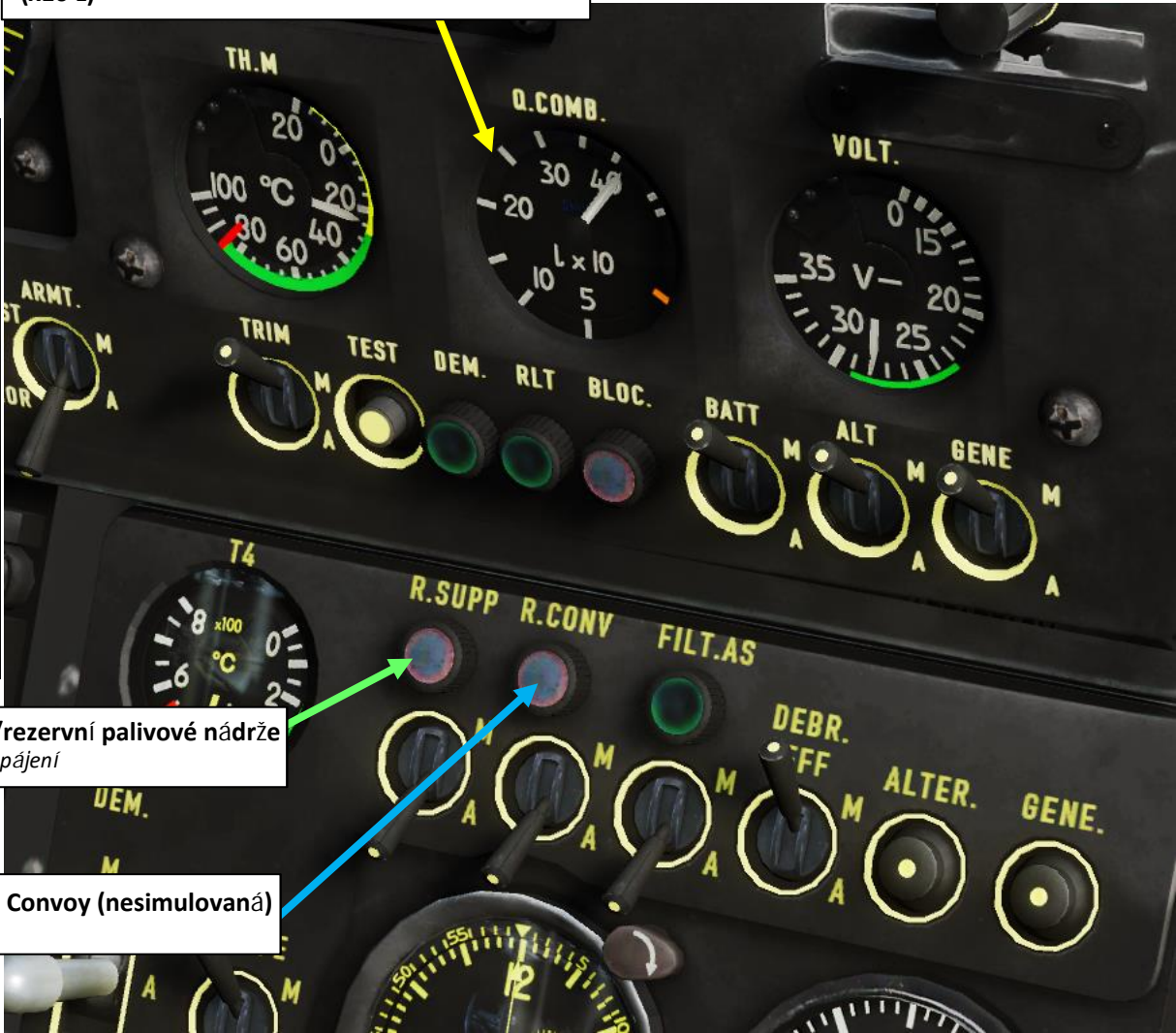
Quantité Combustible / Ukazatel množství paliva (x10 L)
