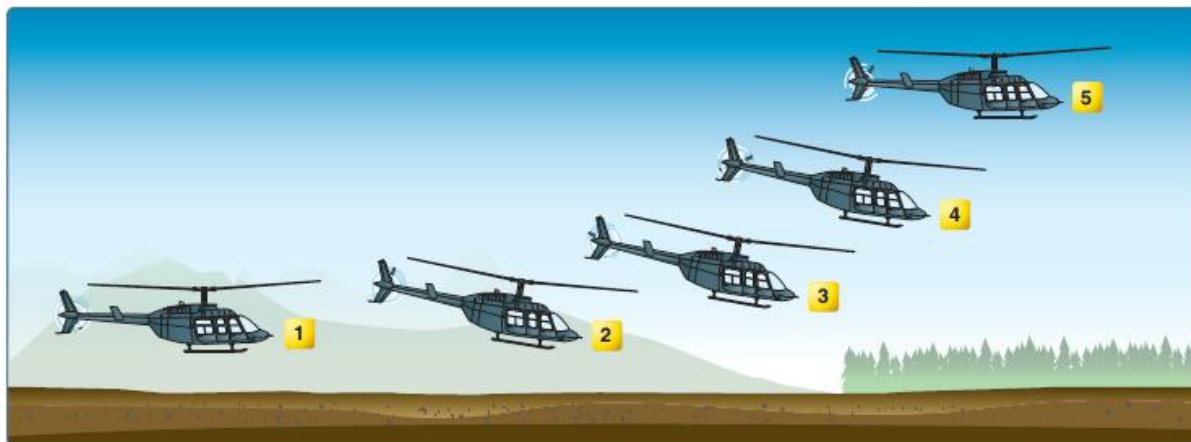
Obrázek 9-7. Během běžného vzletu z visení zaujímá vrtulník několik poloh.
