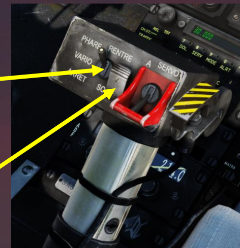
Spínač přistávacího/pátracího světla
