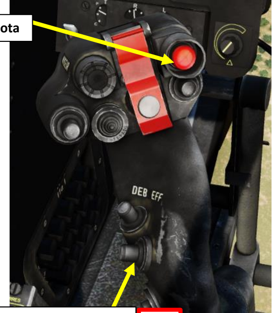
Tlačítko automatického vznášení (klávesa: Q)
